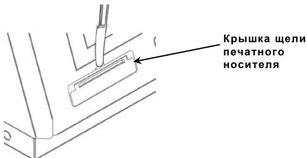
3. С помощью пластмассового ножа нажмите L-образный рычажок. Теперь опорную пластину можно вынуть.
