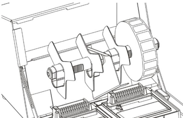
5. Установите внешнюю направляющую печатного носителя на держатель печатного носителя. Зафиксируйте внешнюю направляющую печатного носителя на месте.
