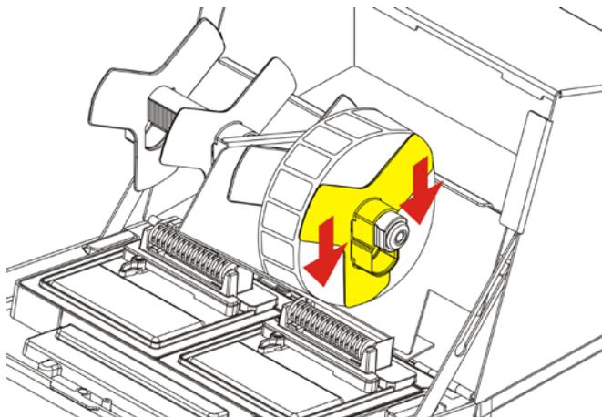
6. Освободите внутреннюю направляющую печатного носителя. Передвиньте внутреннюю направляющую печатного носителя, чтобы она касалась внешней направляющей печатного носителя. Зафиксируйте внутреннюю направляющую печатного носителя в месте, где она касается печатного носителя.
