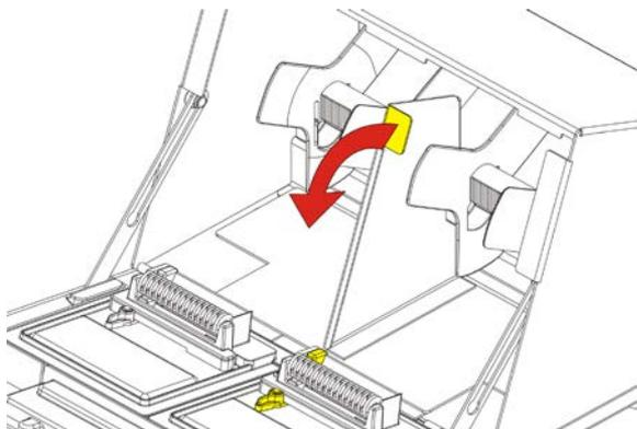
3. Освободите внешнюю направляющую печатного носителя и снимите ее с держателя печатного носителя.
