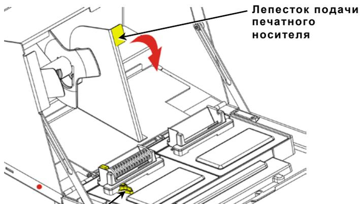
3. Освободите направляющую печатного носителя. Снимите направляющую печатного носителя с держателя носителя.
