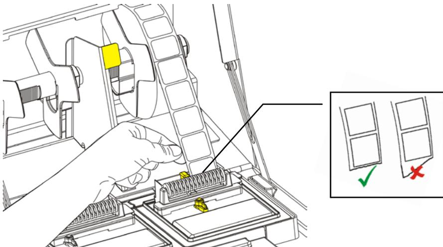
9. Передвиньте лепесток печатного носителя рядом с печатным носителем. Задвиньте рычажок печатного носителя.
