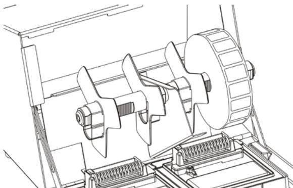
5. Posizionare la guida esterna del supporto di stampa sul reggirotolo. Bloccare in posizione la guida esterna del supporto di stampa.
