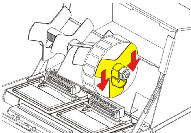
6. Sbloccare la guida interna del supporto di stampa. Spostare la guida interna del supporto di stampa finché il supporto di stampa non tocca la guida esterna del supporto di stampa. Se la guida interna del supporto di stampa è a contatto con il supporto di stampa, bloccarla in posizione.
