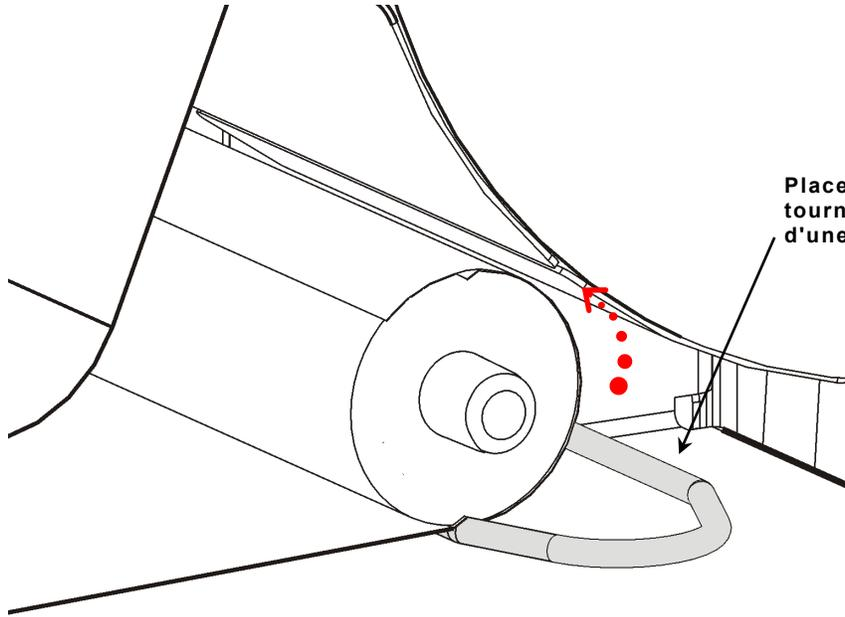
Placer l'étrier dans la rainure et le faire tourner dans le sens inverse des aiguilles d'une montre comme illustré.
