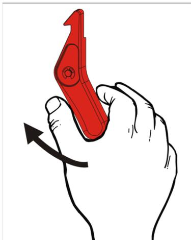
3. Soulevez le mécanisme de la tête d'impression jusqu'à ce qu'il soit correctement installé.
