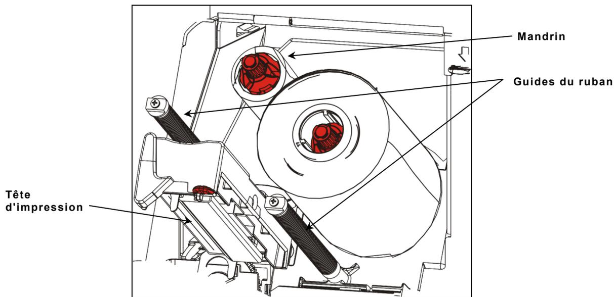
8. Faites soigneusement passer le ruban sous les rouleaux et la tête d'impression.
