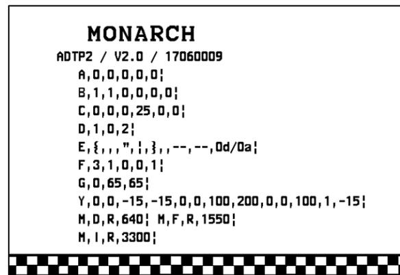
3. Lorsque l'étiquette d'essai souhaitée s'affiche, appuyez sur **PRINT (IMPR.)** Appuyez sur **BACK (PREC)** pour revenir au menu précédent sans imprimer d'étiquette d'essai.
