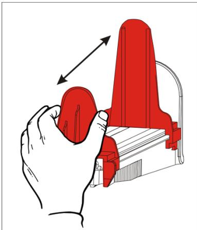
5. Placez ce rouleau sur le porte-support. Les rouleaux d'étiquettes peuvent se dérouler en partant du bas ou du haut ; les rouleaux d'étiquettes cartes doivent se dérouler en partant du bas uniquement (les étiquettes sur le rouleau sont à l'intérieur).
