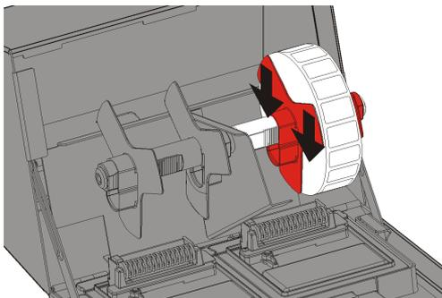
9. Передвиньте лепесток печатного носителя рядом с печатным носителем. Задвиньте рычажок печатного носителя.
