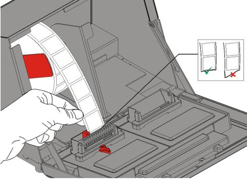
8. Schieben Sie den Materialhebel an das Material. Schließen Sie den Materialhebel.
