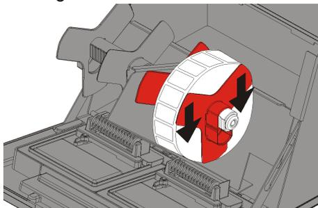
6. Entriegeln Sie die innere Materialführung. Verschieben Sie die innere Materialführung, bis das Material die äußere Materialführung berührt. Verriegeln Sie die innere Materialführung.
