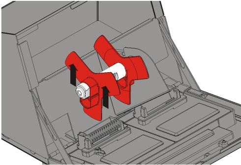
4. Setzen Sie eine Etikettenrolle (bedruckbare Seite nach oben) auf den Materialhalter. Schieben Sie die Materialführung auf den Materialhalter, bis sie das Material berührt.
